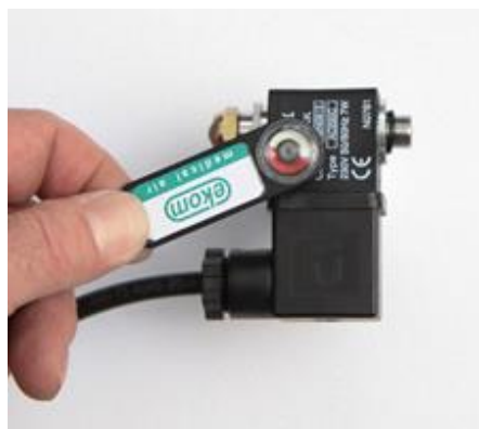
Рис. 24: Проверка работы электромагнитного клапана
