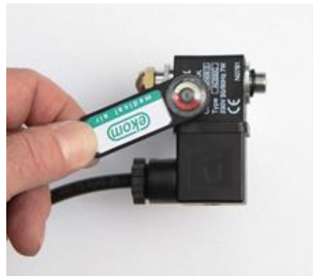
Рис. 28: Проверка работы электромагнитного клапана
