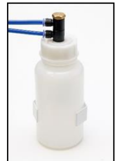
Obr. 18: Kontrola nádoby na zber kondenzátu
