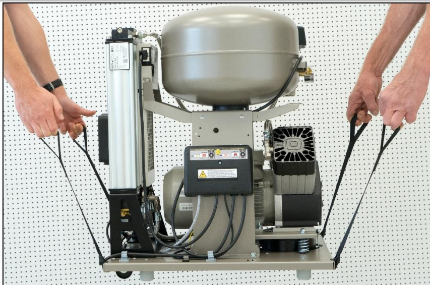
Fig. 4: Manipulation du compresseur à l'aide de sangles de manutention
