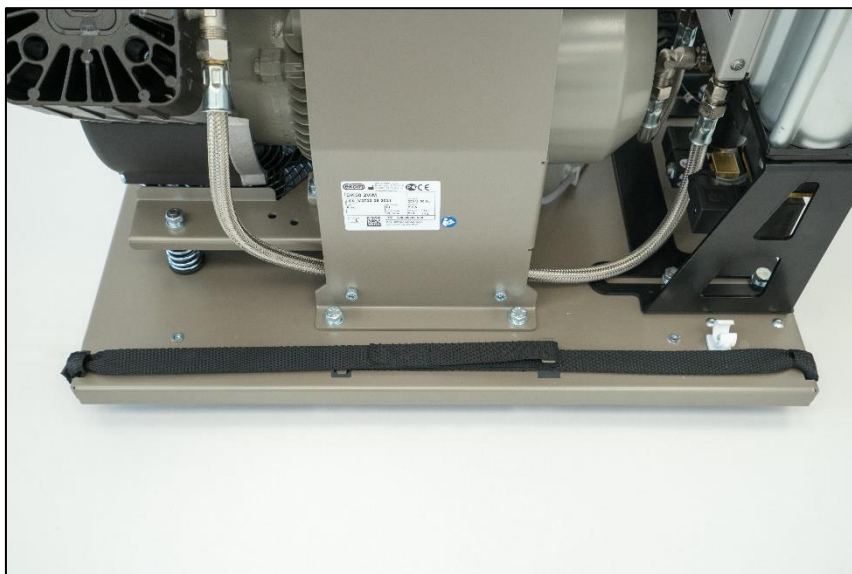
Zaistenie popruhov po ustavení kompresora
