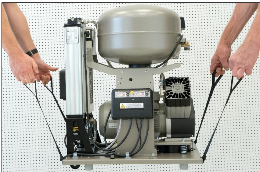
Obr. 4 :Manipulácia s kompresorom pomocou popruhov
