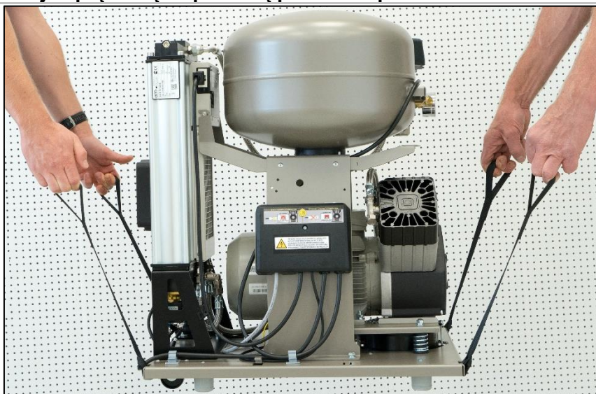
Rys. 4: Manipulacja sprężarką za pomocą pasów do przenoszenia
