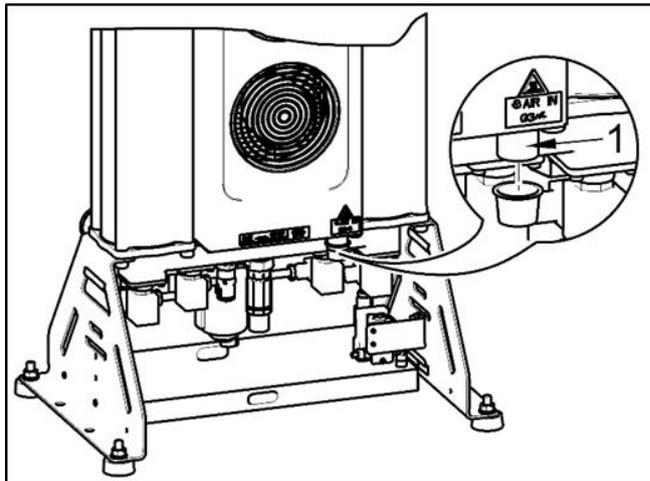
Рис. 9: Вход сжатого воздуха
