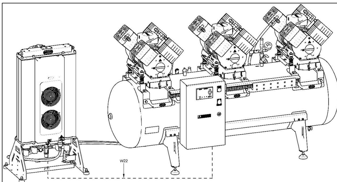
Рис. 14: Подключение жгута проводки управления и кабеля питания
