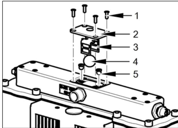
Рис. 24: Замена шарика логического клапана
