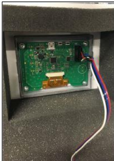
Rys. 17: Podłączenie złącza wyświetlacza
