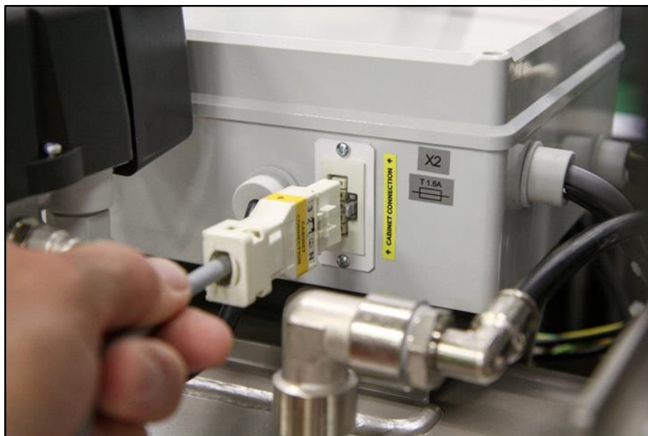
Abb. 13: Anschließen des Gehäuses an den Kompressor
