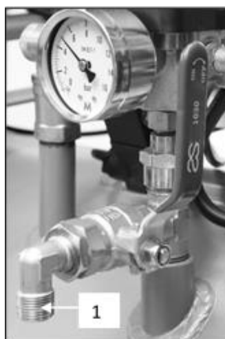
Obr. 8: Pripojenie k výstupu stlačeného vzduchu
