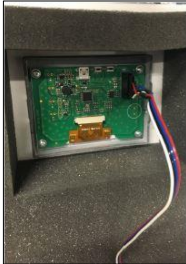
Рис. 17: Подключение разъема дисплея
