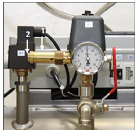
Rys. 25: Kontrola zaworu bezpieczeństwa
