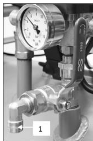
Fig. 8: Raccordement à la prise d'air comprimé
