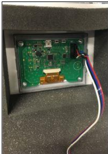
Рис. 17: Подключение разъема дисплея
