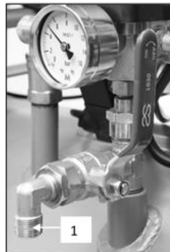
Obr. 8: Pripojenie k výstupu stlačeného vzduchu
