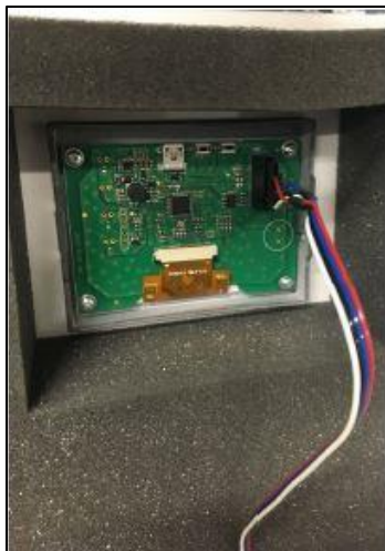
Fig. 17: Branchement du connecteur de l'écran
