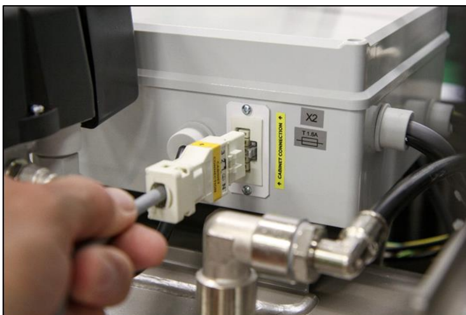
Obr. 13: Zapojení skříňky ke kompresoru
