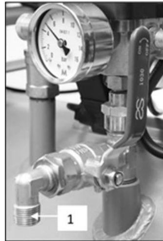
Abb. 8: Anschluss an den Druckluftausgang
