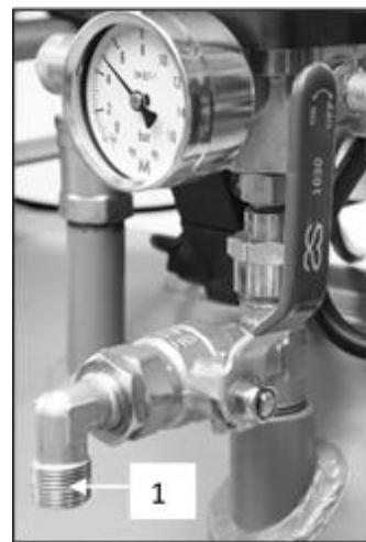
Рис. 8: Подключение к выпускному воздуховоду сжатого воздуха
