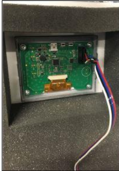
Abb. 17: Anschließen des Displaysteckers
