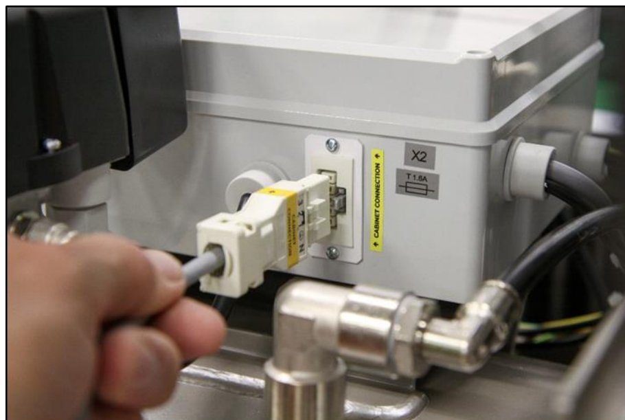
Obr. 13: Zapojenie skrinky ku kompresoru
