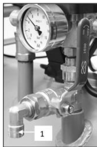
Rys. 8: Podłączanie do wylotu sprężonego powietrza
