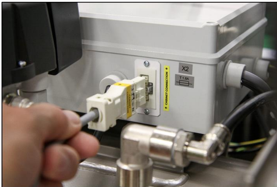
Rys. 13: Podłączanie obudowy do sprężarki
