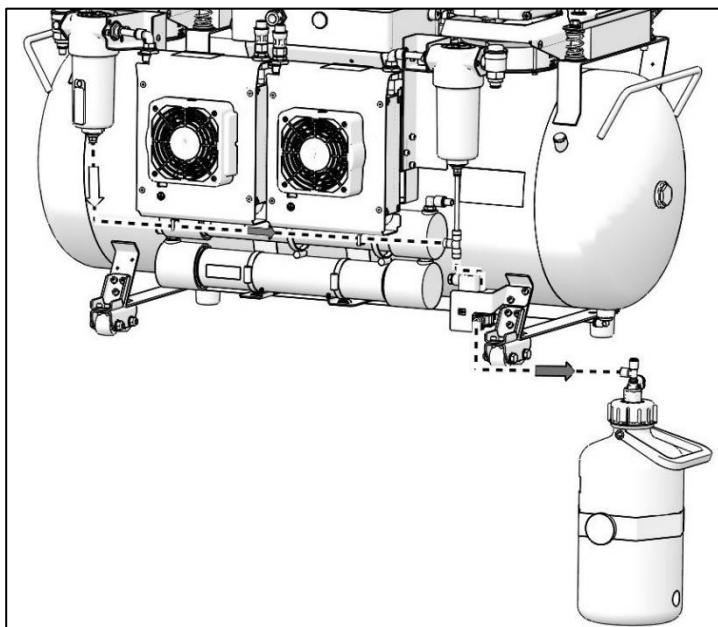
**Rys. 10: Spust kondensatu**
