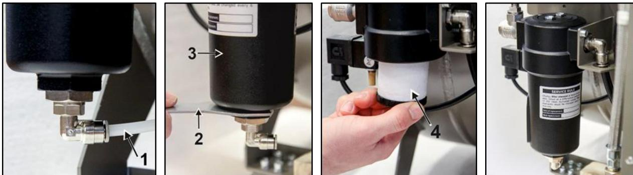
Fig. 19: Remplacement de l'élément filtrant
