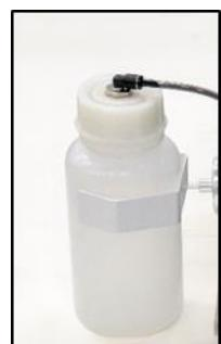
Abb. 16: Überprüfen des Kondensatauffangbehälters
