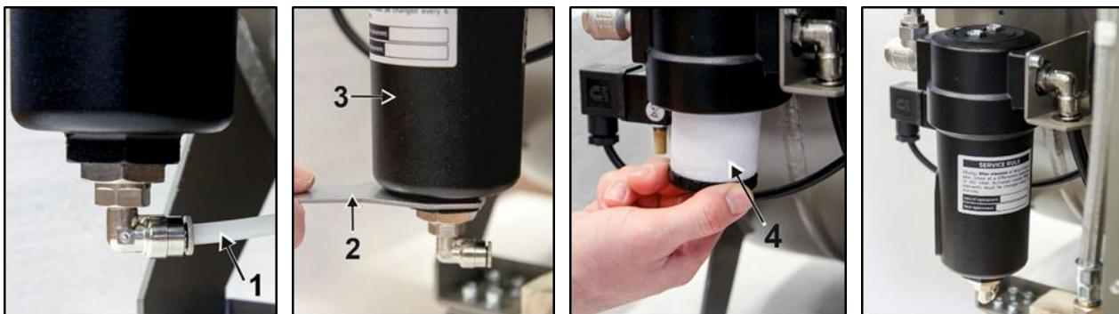
Obr. 19: Výměna filtrační vložky ve filtru
