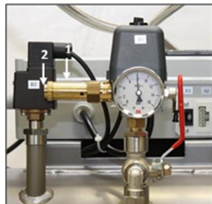
Obr. 17: Kontrola poistného ventilu
