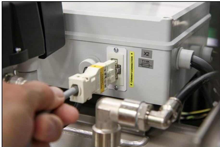
Obr. 13: Zapojení skříňky ke kompresoru
