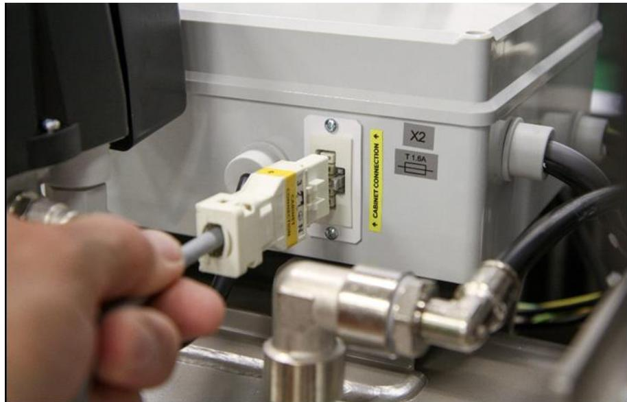
Obr. 13: Zapojenie skrinky ku kompresoru
