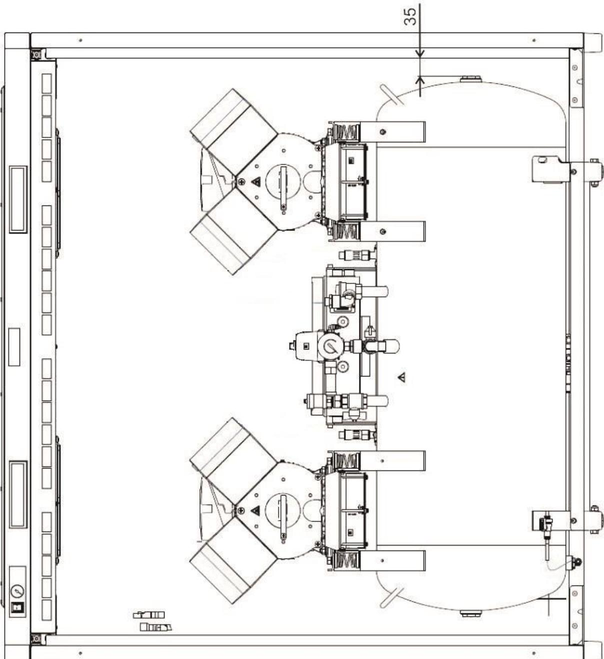
**Obr. 6: Umístění kompresoru do skřínky**
