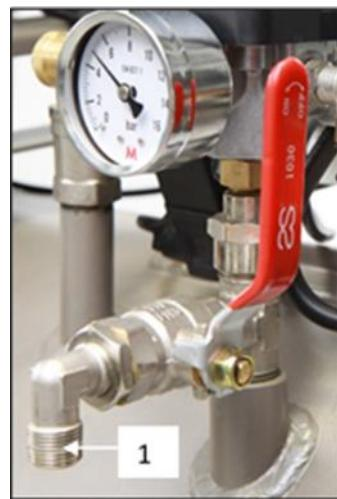
Abb. 8: Anschluss an den Druckluftausgang
