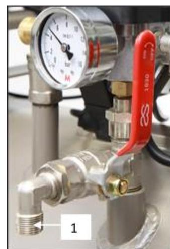
Obr. 8: Pripojenie k výstupu stlačeného vzduchu
