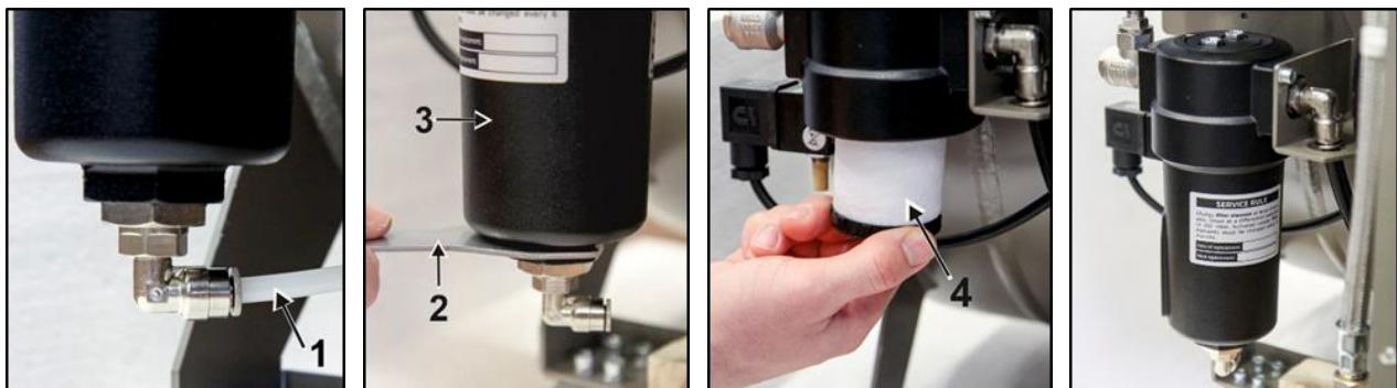
Рис. 19: Замена фильтрующего элемента
