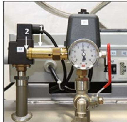
Abb. 17: Sicherheitsventil überprüfen
