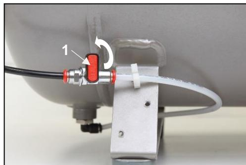
Obr. 15: Vypuštění kondenzátu
