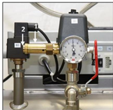
Rys. 17: Kontrola zaworu bezpieczeństwa
