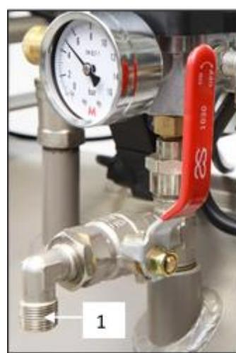
Рис. 8: Подключение к выпускному воздуховоду сжатого воздуха
