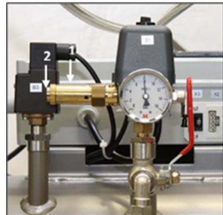
Obr. 17: Kontrola pojistného ventilu
