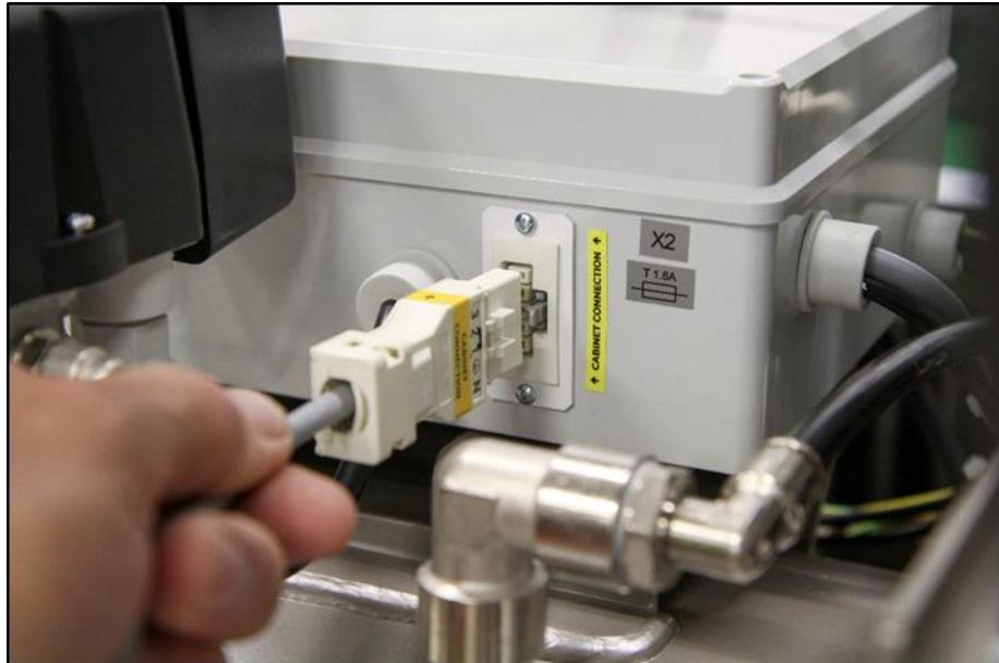
**Рис. 13: Подключение шкафа к компрессору**
