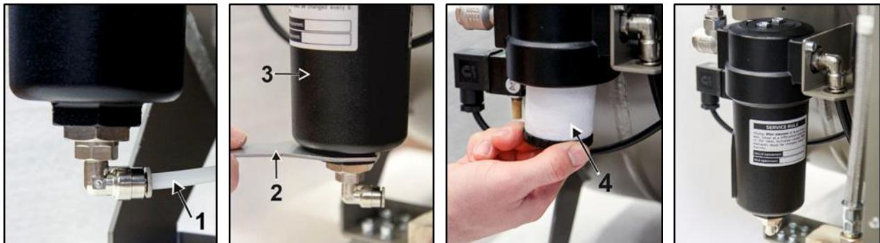
Abb. 19: Austausch des Filterelements
