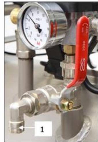
Rys. 8: Podłączanie do wylotu sprężonego powietrza
