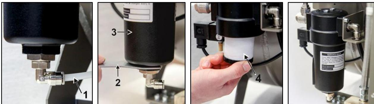
Rys. 19: Wymiana elementu filtracyjnego
