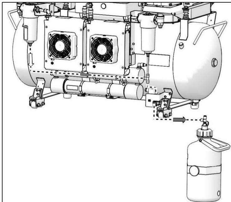
Obr. 10: Výstup kondenzátu
