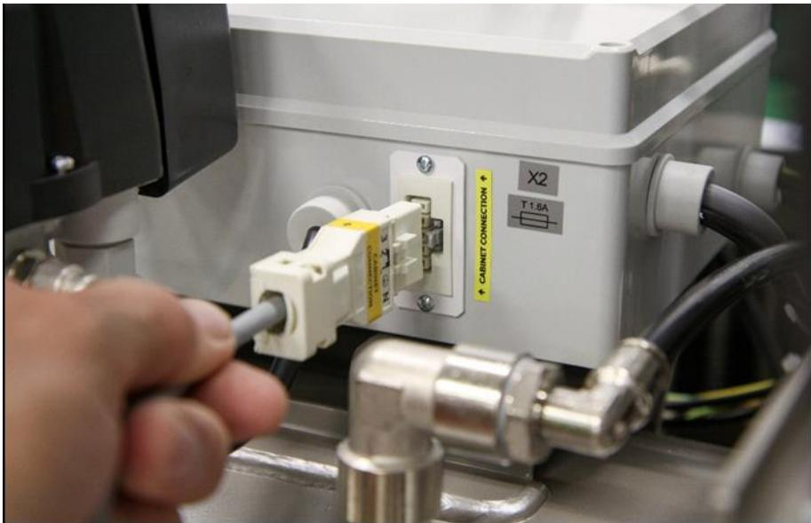
Rys. 13: Podłączanie obudowy do sprężarki
