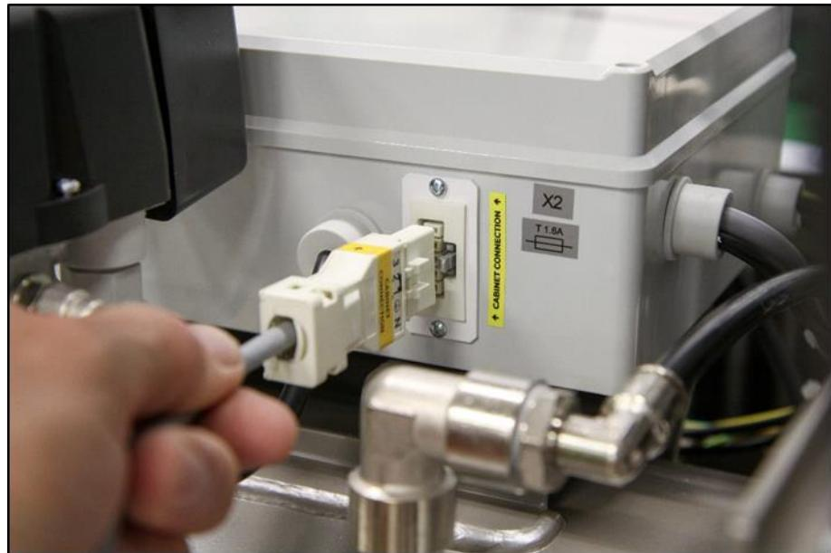
**Abb. 13: Anschließen des Gehäuses an den Kompressor**
