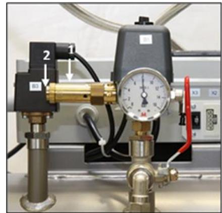
**Fig. 17: Contrôle de la soupape de sécurité**
