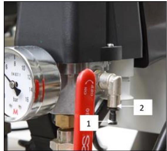
Rys. 9: Podłączanie miernika ciśnienia w obudowie do sprężarki
