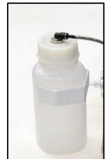
Abb. 16: Überprüfen des Kondensatauffangbehälters
