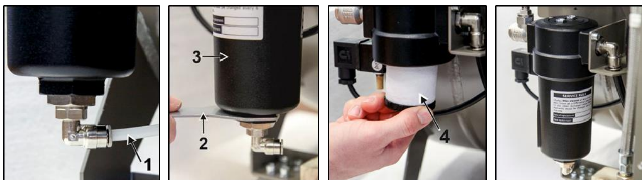
Рис. 19: Замена фильтрующего элемента
