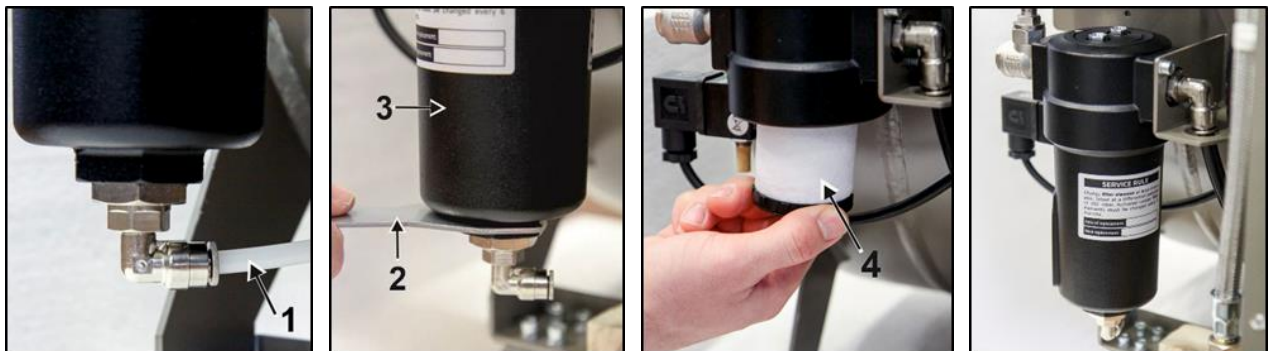
Abb. 19: Austausch des Filterelements
