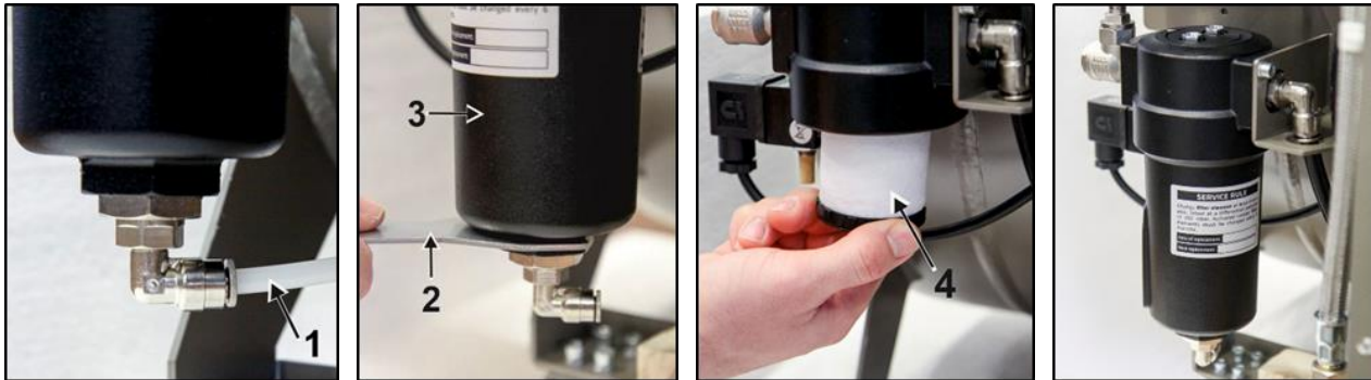
Obr. 19: Výmena filtračnej vložky vo filtri
