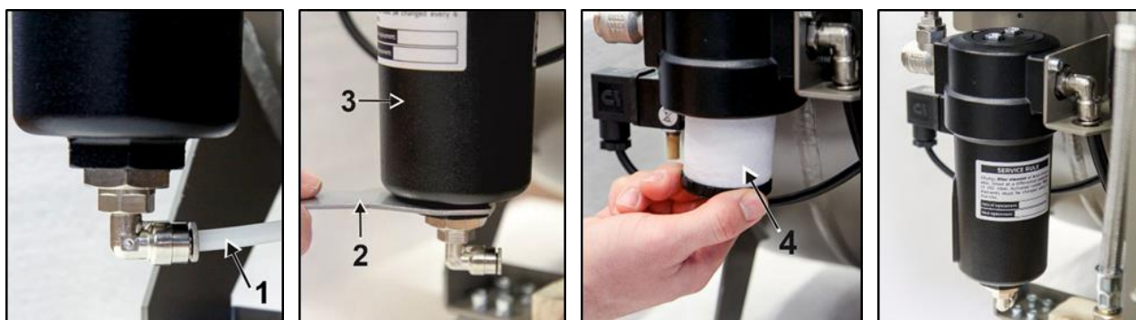
Rys. 19: Wymiana elementu filtracyjnego
