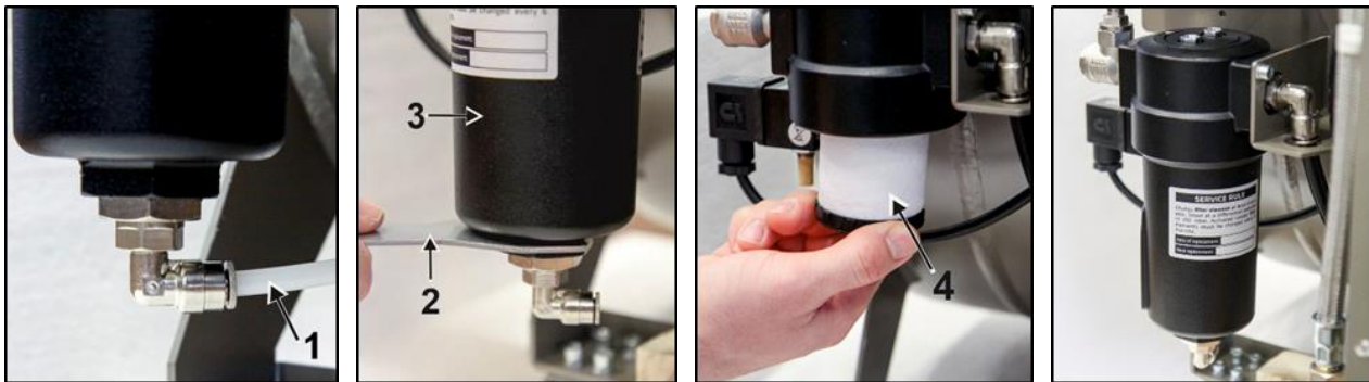
Obr. 19: Výměna filtrační vložky ve filtru
