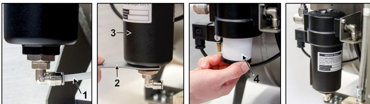
Fig. 19: Remplacement de l'élément filtrant
