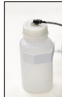
Obr. 16: Kontrola nádoby na zber kondenzátu
