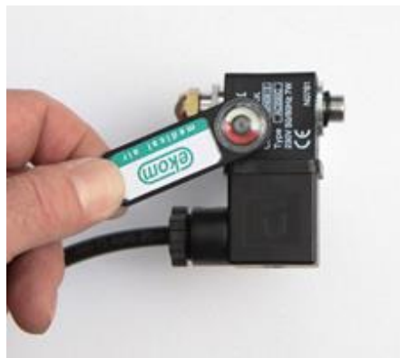
Рис. 24: Проверка работы электромагнитного клапана
