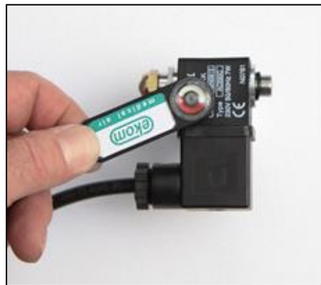
Рис. 19: Проверка работы электромагнитного клапана
