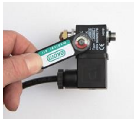
Рис. 28: Проверка работы электромагнитного клапана
