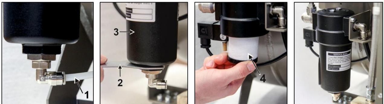
Abb. 18: Austausch des Filterelements
