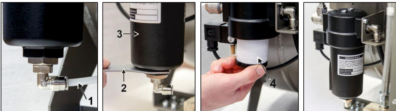
Obr. 18: Výmena filtračnej vložky vo filtri
