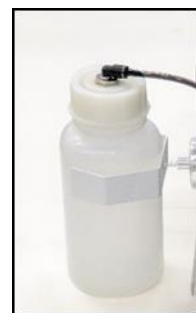
Obr. 15: Kontrola nádoby na zber kondenzátu
