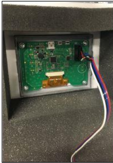
Abb. 17: Anschließen des Displaysteckers
