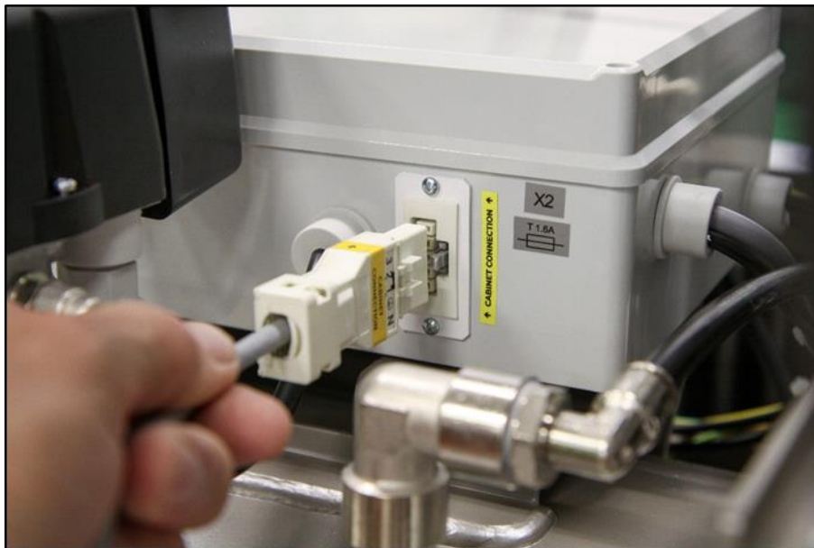
Abb. 13: Anschließen des Gehäuses an den Kompressor
