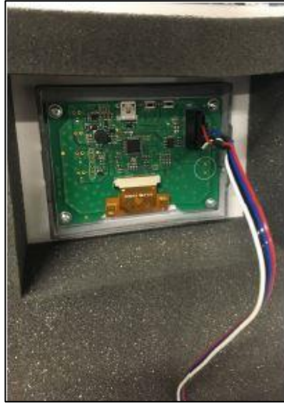
Abb. 17: Anschließen des Displaysteckers
