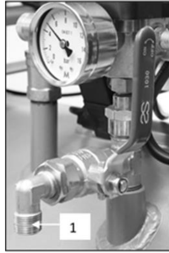
Abb. 8: Anschluss an den Druckluftausgang
