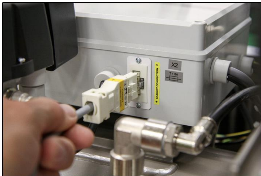
Abb. 13: Anschließen des Gehäuses an den Kompressor
