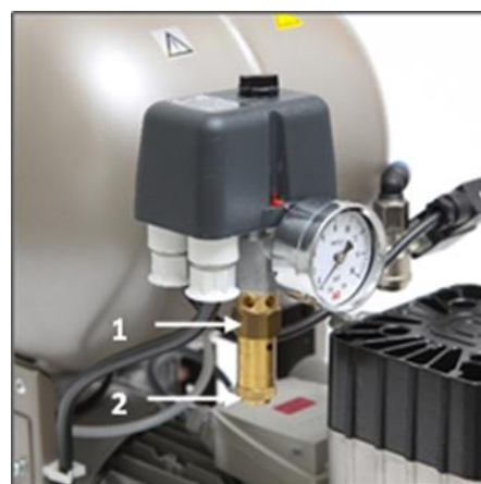
Рис. 7: Проверка предохранительного клапана
