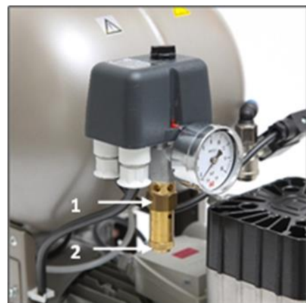
Rys. 7: Kontrola zaworu bezpieczeństwa
