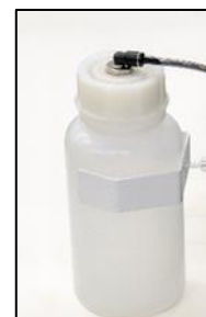
Obr. 17: Kontrola nádoby na zber kondenzátu
