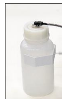
Obr. 16: Kontrola nádoby na zber kondenzátu
