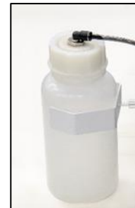
Obr. 5: Kontrola nádoby na zber kondenzátu
