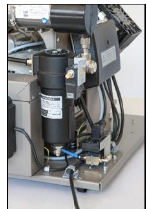
Abb. 9: Austausch des Filterelements
