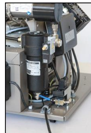
Obr. 9: Výmena filtračnej vložky vo filtri
