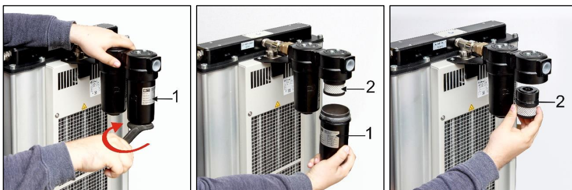
Obr. 24: Výmena filtračnej vložky vo filtri
