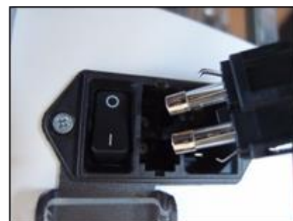
Abb. 25: Austausch von Sicherungen
