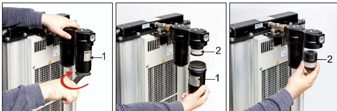
Abb. 24: Austausch des Filterelements
